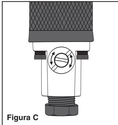
Ajuste la velocidad girando el tornillo interior en el sentido horario o contra-horario usando un destornillador de pala plana hasta obtener el flujo de aire deseado.
