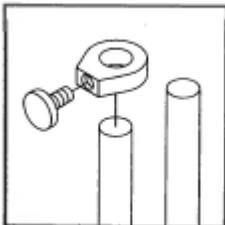
Los toques de profundidad permiten el ajuste a cualquier profundidad de corte, dentro de la capacidad. Baje los toques completamente hacia la parte inferior de las varillas de guía cuando esté cortando material en dos pedazos.
