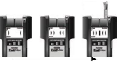
Les charges d'électricité statique pouvant se développer sur les murs de plâtre et autres surfaces élargiront la zone de détection de tension de plusieurs centimètres de chaque côté du fil électrique. Pour aider à situer la position du fil, balayez en tenant l'unité à 12,7 mm (1/2 po) de la surface du mur ou placez votre autre main sur la surface à environ 30 cm (12 po) de l'unité.
