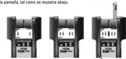
Cargas de electricidad estática que se pueden desarrollar sobre paredes de yeso (drywall) y otras superficies, ampliarán el área de detección de voltaje muchas pulgadas hacia cada lado del cable eléctrico. Para ayudar a localizar la posición del cable, escanéelo sujetando la unidad retirada 12,7 mm ( $\frac{1}{2}$  pul.) de la superficie de la pared o coloque su otra mano sobre la superficie a aproximadamente 30 cm (12 pul.) del sensor.
