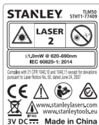
STHT1-77409 verktyget utstrålar en synlig laserstråle, såsom visas i bild A. Laserstrålen som utstrålas är Laserklass 2 per IEC 60825-1 och uppfyller 21 CFR 1040.10 och 1040.11 förutom för avvikelse enligt Lasemotering nr. 50, daterad 24 juni, 2007.
