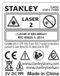
Unealta STHT1-77409 emite un fascicul laser vizibil, aşa cum este prezentat în Figura A. Fasciculul laser emis este unul laser clasa 2 conform IEC 60825-1 și respectă prevederile 21 CFR 1040.10 și 1040.11, cu excepția discrepanțelor în conformitate cu avizul privind produsele cu laser Nr. 50 din 24 iunie 2007.
